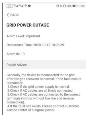
Kuva 7-9 Vikahälytyksen tarkat tiedot
